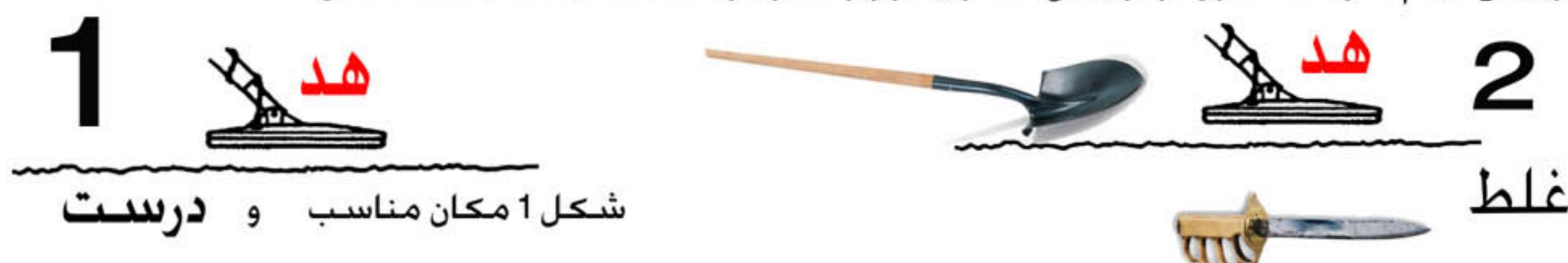
شکل 2 نشان میدهد که در کنار هد یک بیل وجود دارد و همینطور در زیر خاک یک خنجر وجود دارد این مکان برای بالانس مناسب نیست و این قطعات فلزی را قبل از شروع گراند بالانس باید از منطقه دور و یا بالانس را در منطقه دیگر اخراج داد
