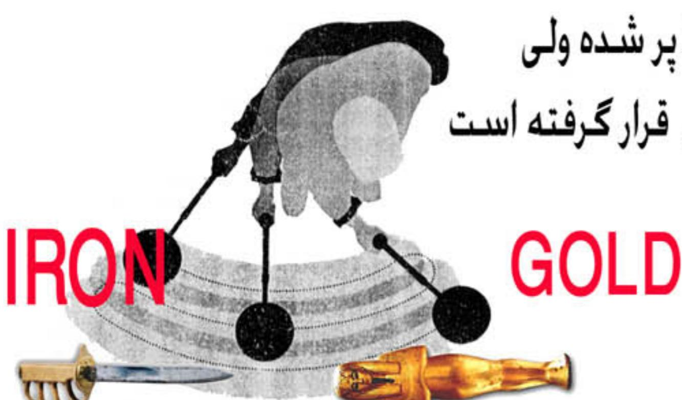
اگر در هنگام کار دو نوع فلز را شناسایی میکند یا امپر کاملا پرشده ولی عمل تفکیک انجان نمیشود احتمالاً دونوع فلز در کنار یکدیگر قرار گرفته است
