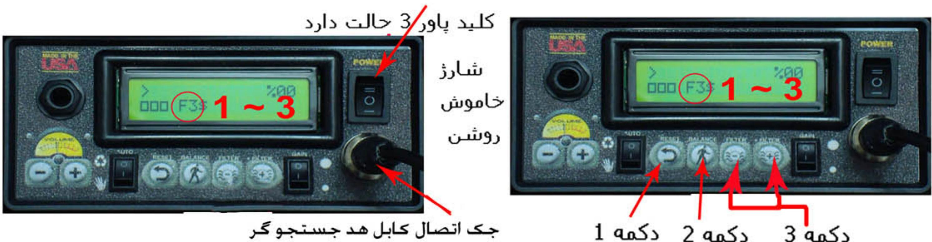
اول کابل هد را به دستگاه وصل کنید و مهره انرا کاملا مهکم کنید و کلید پاور را تا انتهای بسمت پایین فشار دهید تا دستگاه روشن شود سپس کد رمز را وارد کنید چند لحظه صبر کنید تا دستگاه اماده کار شود سپس دکمه شماره 2 را فشار دهید تا گراند بالانس شروع شود چند دقیقه صبر کنید تا دستگاه با نمایش **ADJUST OK** پایان گراند بالانس را اعلان کند توجه : در زمان استفاده از دستگاه هر گاه نیاز به صفر کردن
