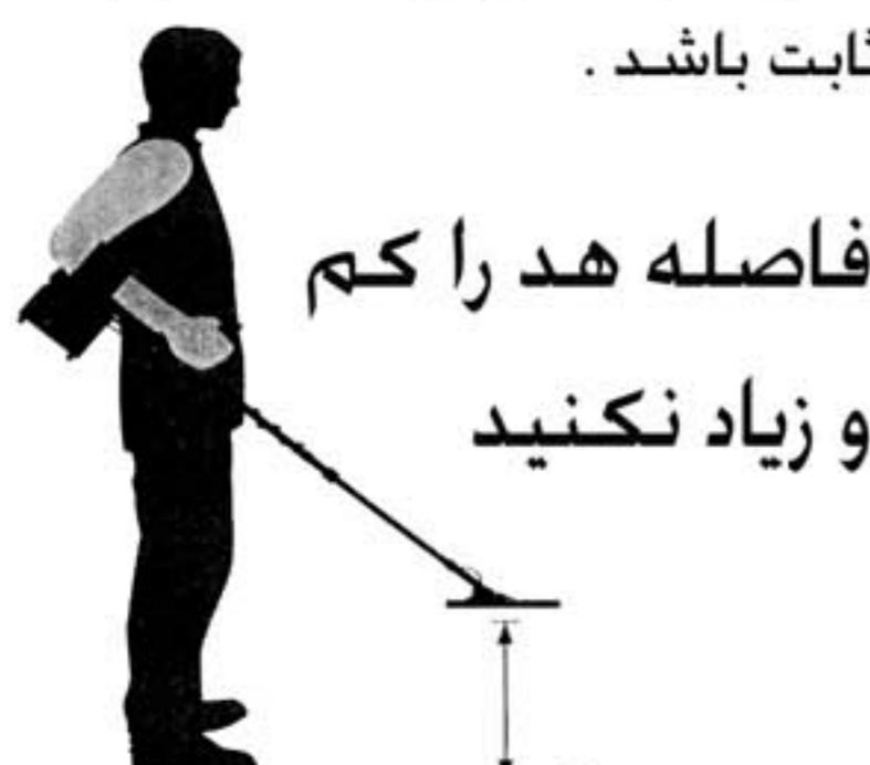
از این روش در مکانهای تقریباً مسطح استفاده میشود حالت 1 و هرگاه دستگاه نیاز به تنظیم داشته باشد باید دگمه شماره 1 را فشار دهید تا دستگاه میزان شود
